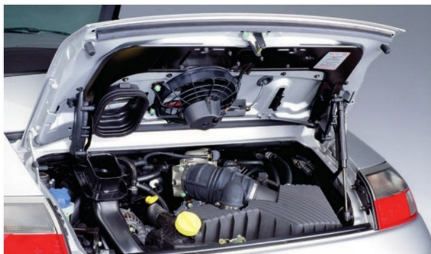
C'est le premier moteur refroidi par eau sur la 911. A l'époque, c'était une hérésie. Aujourd'hui, personne n'y pense.
